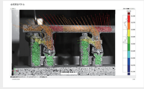
レールのひずみ解析 (DIC)
