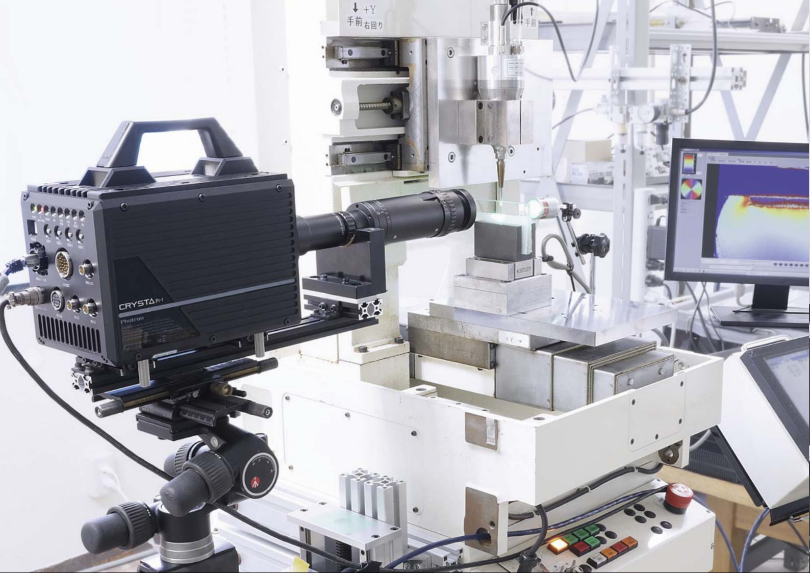
精密加工における被削材内部の位相差分布を高速度かつ高倍率に観察
