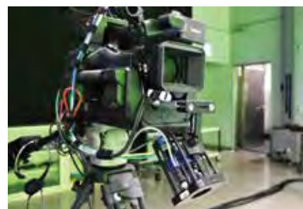
TrackMen社の非接触型センサーを取り付けた撮影用カメラ
