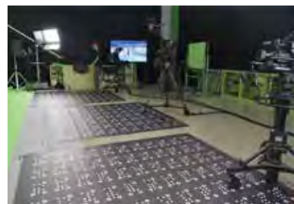
3台のカメラそれぞれに「VioTrack F」専用マーカーシートを設置
