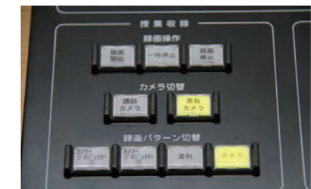
教卓に組み込まれた講義収録関連のスイッチ。収録の開始/停止、カメラ切り替え、収録パターン切り替えなどの操作を教員の手許で行える。
