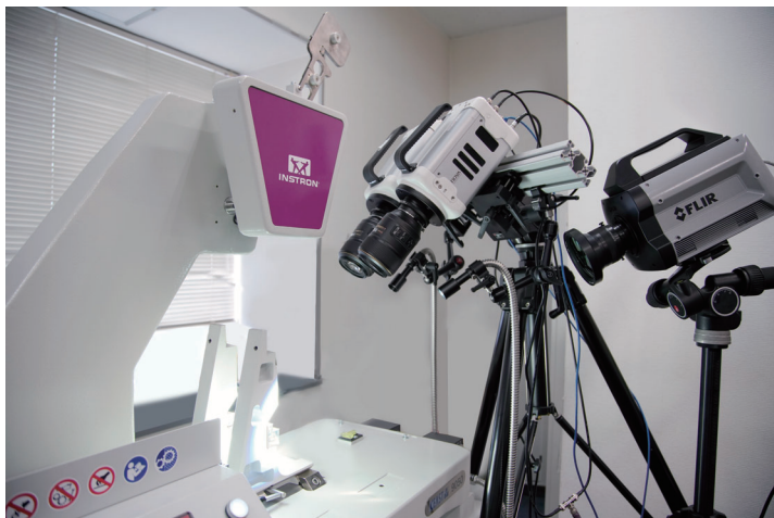
シャルピー衝撃試験での設置例
