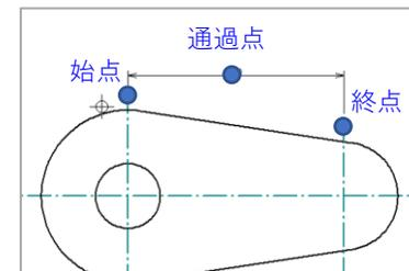
左右の寸法線の通過点を揃えてみます。後から揃えなくても、先に水平補助線を引いて、それに合わせて作図しても同じことができます。
