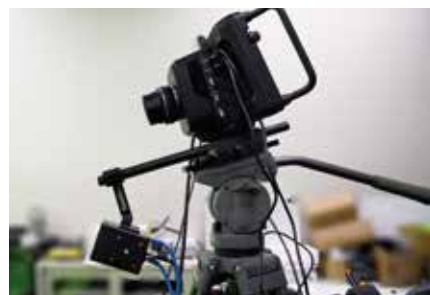
撮影用カメラにPixotopeのセンサーカメラを取付
